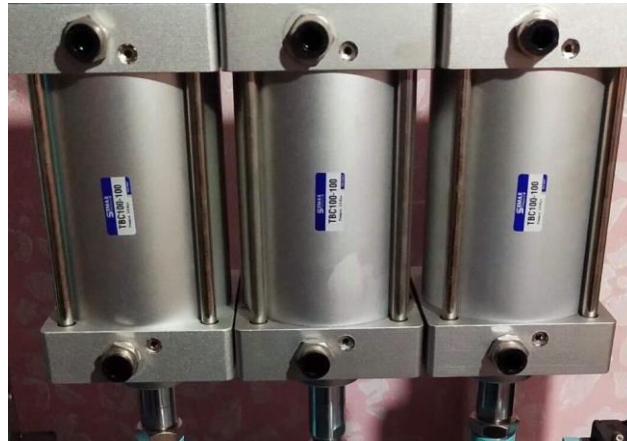
ภาพที่ 5 การติดตั้งชุดส่งกำลังของเครื่องตัด
