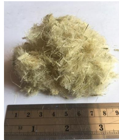
รูปที่ 2 แสดงลักษณะของเส้นใยใบสับปรดบดหยาบ ที่นำมาใช้เป็นสารตัวเติม
