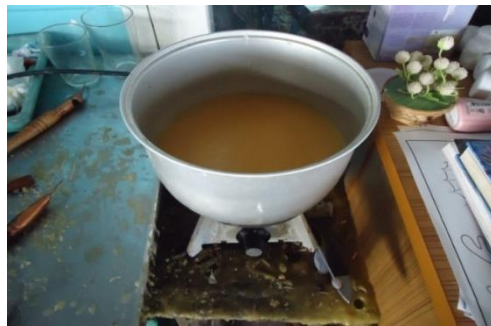
ภาพที่ 2 หม้ออลูมิเนียมและเตาสำหรับต้มเทียน เทียนไข
