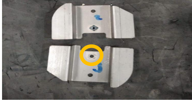
รูปที่ 1 ตัวอย่างลักษณะของเสียที่เกิดจากกระบวนการเชื่อมความต้านทานแบบปั๊ม
