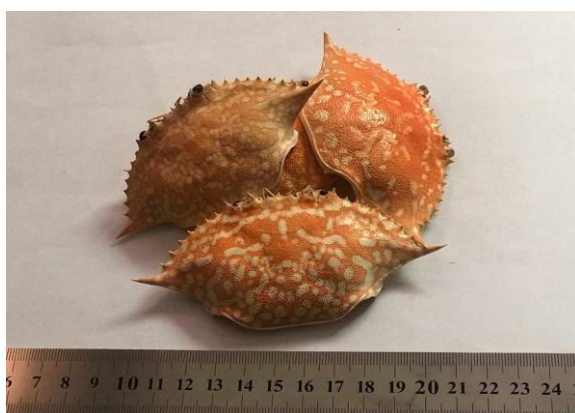
ภาพที่ 1 แสดงลักษณะของกระดองปูที่เหลือทิ้งจากอุตสาหกรรมการประมงที่นำมาใช้เป็นสารตัวเติม
