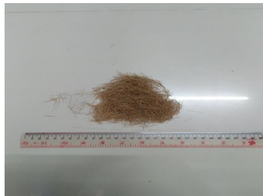
ข. ลักษณะของดอกอ้อที่ตัดเป็นเส้นเพื่อใช้เป็นสารตัวเติม
