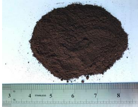
ข. กากกาแฟที่ผ่านการบดละเอียดและอบให้แห้ง
