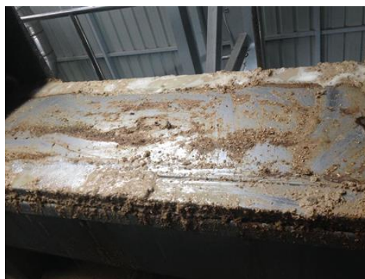
รูปที่ 4 ฝาปิดสกรูลำเลียงกากข้าวที่มีร่องแบบเก่า
