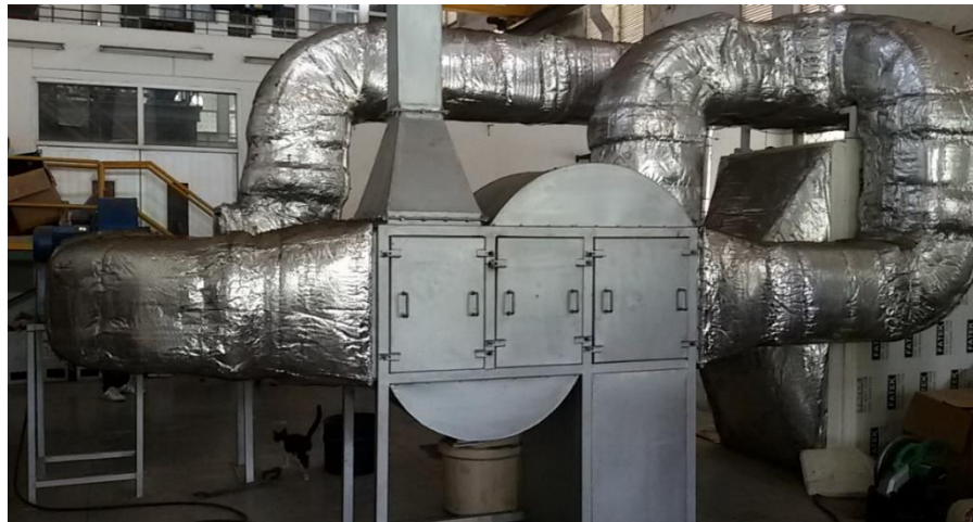
ภาพที่ 3 ระบบผลิตลมร้อนด้วยเตาซีมวอลแบบสลับทิศทางการไหล
