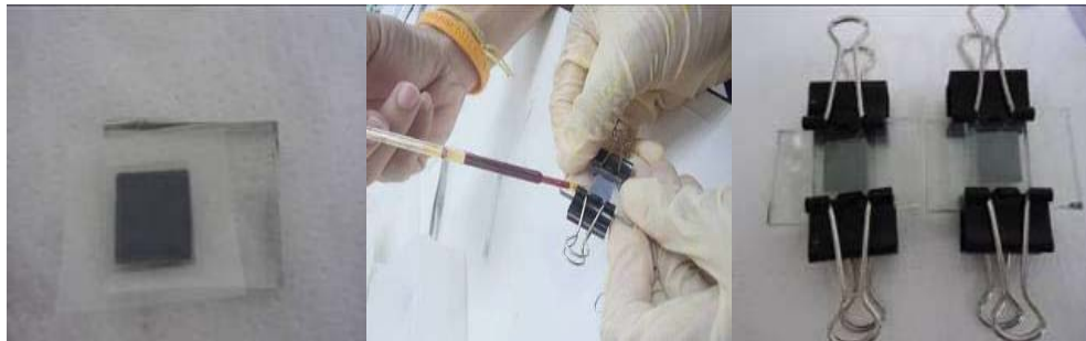
ภาพที่ 1 การประกอบเซลล์แสงอาทิตย์ชนิดสีย้อมไวแสง
