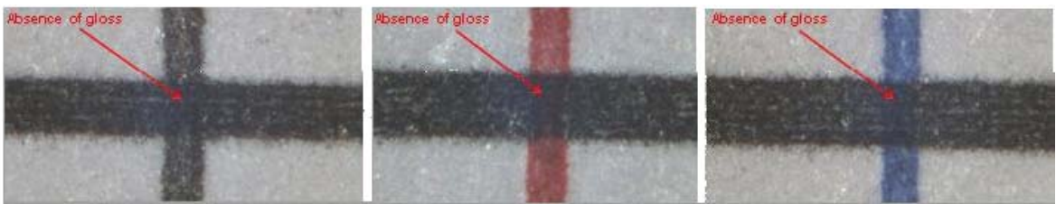
ภาพที่ 2 แสดงผลการทดลองไม่ปรากฏลักษณะความมันวาวตรงบริเวณจุดตัดกันของเส้นหมึก ในกรณีที่เส้นหมึกปากกาหมึกลูกกลิ้งและปากกาหมึกเจล (สีดำ สีแดง และสีน้ำเงิน) ถูกซ้อนทับด้วยหมึกพิมพ์เลเซอร์สีดำ โดยใช้กำลังขยาย 95 เท่า ด้วยเครื่อง Docucenter expert (PIA 6000)
