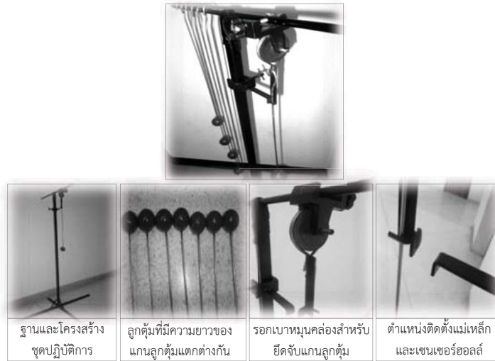
รูปที่ 2 โครงสร้างเครื่องมือปฏิบัติการเรื่องการแกว่งของลูกตุ้มอย่างง่าย
