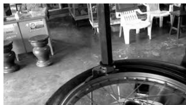
รูปที่ 3 แสดงการกดยางของหัวกดยางและการจัดขอบยาง
