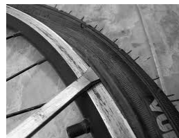
รูปที่ 1 ลักษณะวงล้อและการถอดยางในรถจักรยานยนต์
