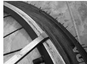
รูปที่ 3 แสดงการกดยางของหัวกดยางและการจัดขอบยาง
