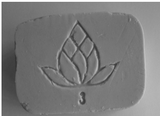
ภาพที่ 12 เนื้อสบูใช้ใบกวนแบบกังหันแบน (Flat blade turbine)
