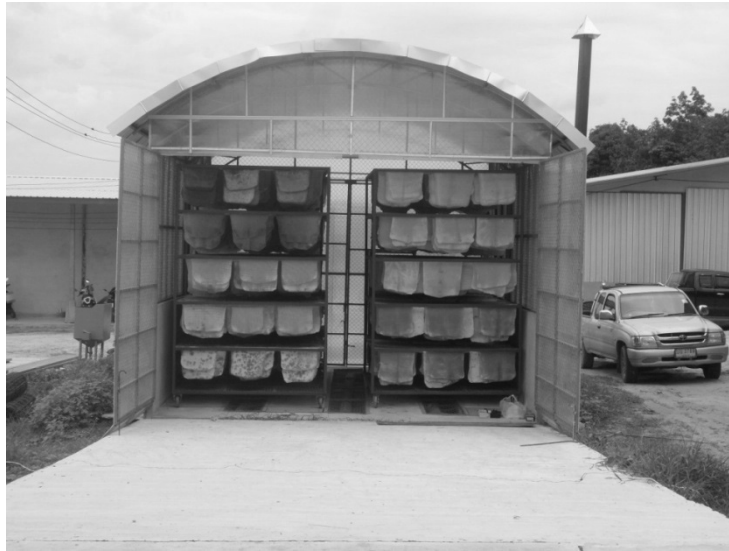
รูปที่ 1 ภาพการอบแผ่นยางพาราในโรงอบยางพาราพลังความร้อนร่วม
