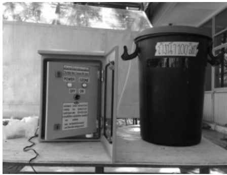
รูปที่ 11 นำเครื่องกำเนิดโอโซนไปบำบัดกับน้ำ 100 ลิตร
