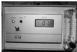
(ก) เครื่องวัดปริมาณโอโซนรุ่น GM-6000-OEM
