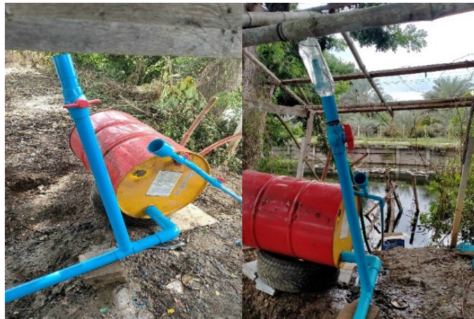
ภาพที่ 5 ระบบป้อนน้ำเข้าถังแรงดันสามารถควบคุมการไหลเข้าและออกพื้นที่การเกษตร
