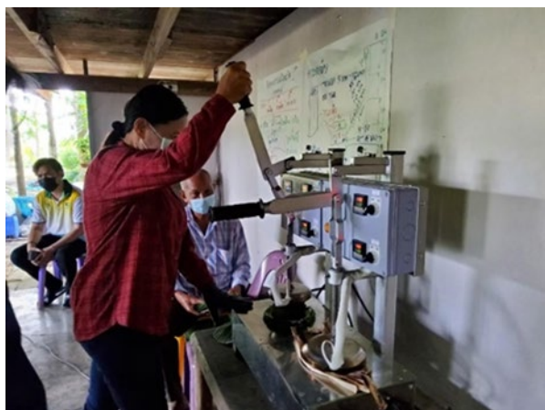
ภาพที่ 1 แสดงเครื่องผลิตภาชนะใบไม้เพื่อการผลิตระดับชุมชน (Leaf Plate Making Machine for Community Production) รุ่นที่ 3 มีโยกสองหัวกด ขนาดเส้นผ่าศูนย์กลาง 8 ซม. และ 12 ซม.
