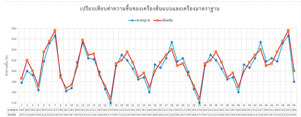
ภาพที่ 10 ผลการทดลองวัดค่าความชื้นข้าวเปลือกด้วยเครื่องวัดความชื้น KETT รุ่น PM-450 กับระบบที่พัฒนาขึ้น
