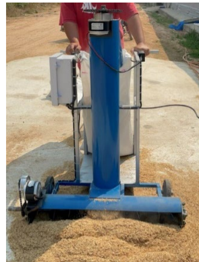
ภาพที่ 1 เครื่องจัดเก็บและบรรจุซี่ไถ่ใส่กระสอบ
