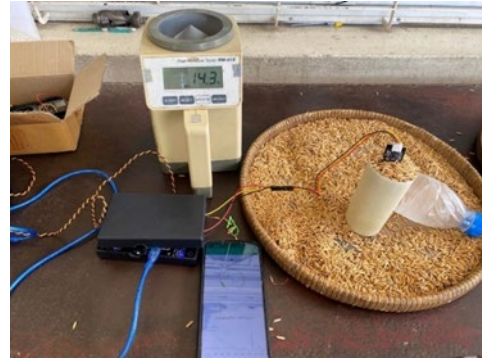
ภาพที่ 3 เครื่องวัดความชื้น KETT รุ่น PM-450 กับระบบ ฯ ที่พัฒนาขึ้น
