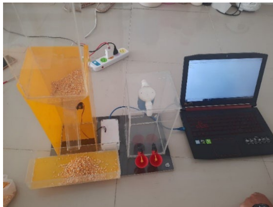
ภาพที่ 4 การตรวจสอบความถูกต้องและแม่นยำของการวัดค่าน้ำหนักของอาหาร
