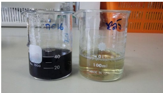
ภาพที่ 2 น้ำเสียสีขุ่นก่อนกวนผสม (ซ้าย) และน้ำส่วนใสหลังตกตะกอน (ขวา)
