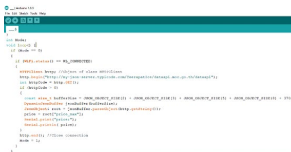
ภาพที่ 6 วิธีการดึงราคากลางมาแสดงผลบนแอปพลิเคชัน
