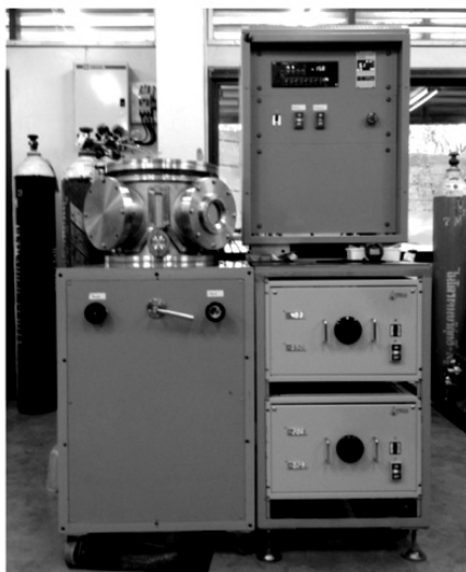
รูปที่ 1 ลักษณะและไดอะแกรมของเครื่องเคลือบในสุญญากาศระบบสปัตเตอร์ริงที่ใช้ในงานวิจัย
