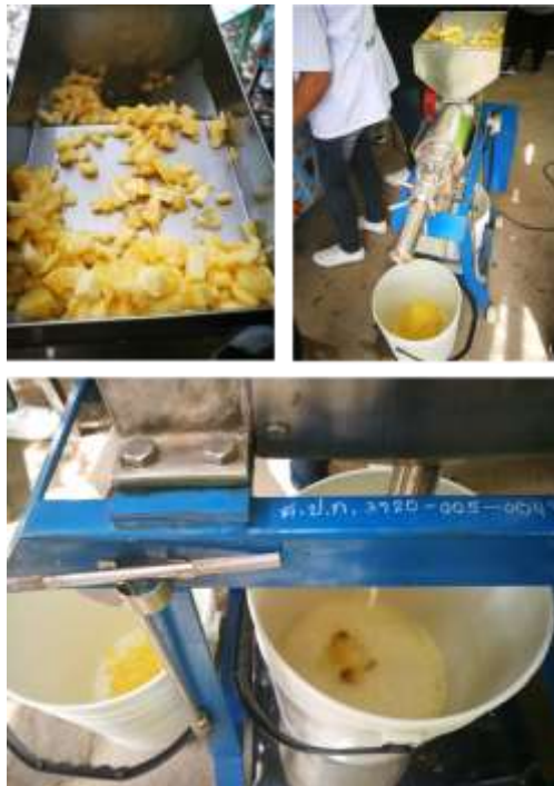
ภาพที่ 4.5 การคั้นน้ำและแยกกากสับปรดเพื่อเตรียมทำสับปรดกวน ที่มา : ชนภัทร ผดุงอรุณ และคณะ, 2560
